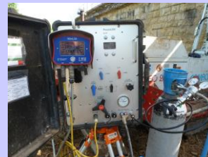
Instrumentation paramètres de forages et essais pressiométriques
